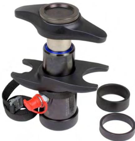
Darüber hinaus kann die Position der beiden Werkzeuge am Zylinder gewechselt werden, um so eine besonders gute Zugänglichkeit bei engen Platzverhältnissen zu Stabilisatoren oder verdeckte Steuerungslenkungen z.B. in Bussen etc. zu erhalten. Der Hydraulikzylinder drückt bis zu **8,8 Tonnen** und ermöglicht somit einen einfachen und reibungslosen Ausbau.
