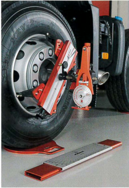
Der Josam Laser AM ist ein Vermessungssystem für Räder, Achsen und Rahmen von Lkw für unterwegs.
